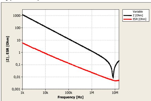
$V_{DC} = 0\text{ V}$ ,  $V_{AC} = 0.5\text{ V}_{RMS}$ ,  $T_{device} = 25\text{ °C}$
