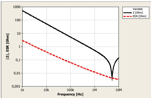
$V_{DC} = 0\text{ V}$ ,  $V_{AC} = 0.5\text{ V}_{RMS}$ ,  $T_{device} = 25\text{ °C}$
